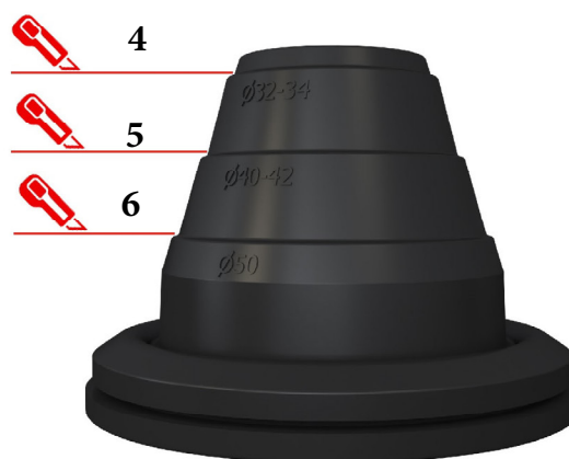
Kapning av rör genomföring 32-50mm används vid Specialbeställd schaktbotten.
